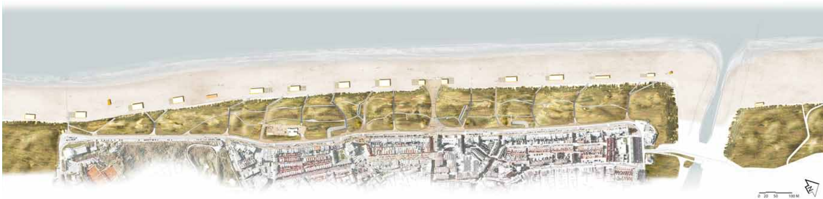
Ontwerptekening met de 'zachte' overgang tussen Katwijk en de zee ten behoeve van kustbescherming.
